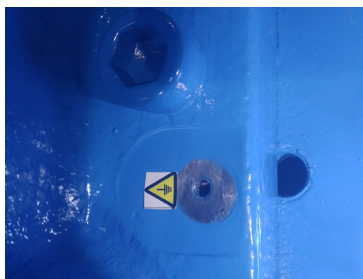
图 5.1 机器人底座地线连接处
