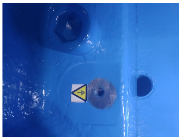
图 5.1 机器人底座地线连接处
