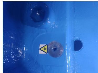
图 5.1 机器人底座地线连接处
